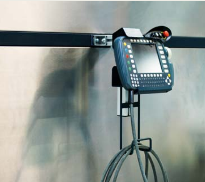
Control panel of the Gavaro electroplating robot // Pannello di controllo del robot di galvanizzazione Gavaro // Panel de control del robot galvanizador Gavaro
