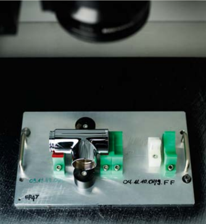
Laser system and device for applying the logo // Impianto laser e dispositivo per l'applicazione del logo // Instalación láser y dispositivo para la incorporación del logo
